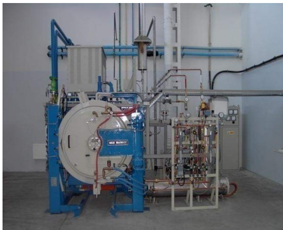
Sinter presa: 60 bar
